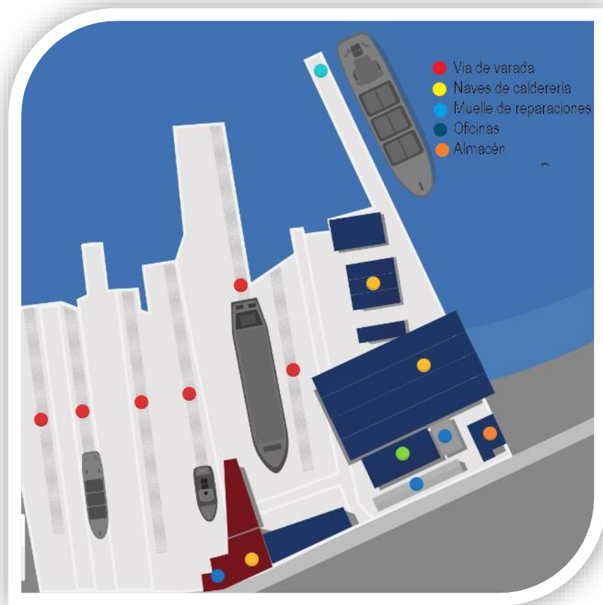
Ilustración 11: Esquema de la distribución de las instalaciones de ASTILLEROS CARDAMA
